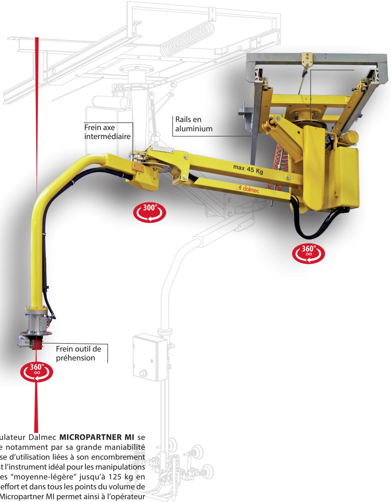
Le manipulateur Dalmec **MICROPARTNER MI** se caractérise notamment par sa grande maniabilité et souplesse d'utilisation liées à son encombrement réduit. Il est l'instrument idéal pour les manipulations des charges "moyenne-légère" jusqu'à 125 kg en absence d'effort et dans tous les points du volume de travail. Le Micropartner MI permet ainsi à l'opérateur de travailler sans fatigue, avec rapidité et précision, dans des conditions optimales d'ergonomie et de sécurité.
