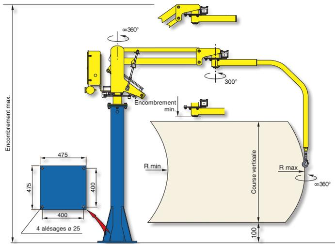
Versions proposées: sur colonne fixée au sol, sur embase autostable de notre fourniture, ou sur chariot autostable motorisé mobile sur un rail posé (ou encastré) sur le sol.
