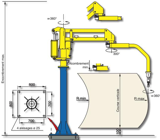
Versions proposées: sur colonne fixée au sol, sur embase autostable de notre fourniture, ou sur chariot autostable motorisé mobile sur un rail posé (ou encastré) sur le sol.
